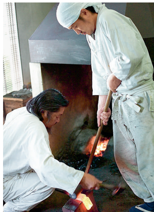
Oben: Der Stahl, der zum Fertigen von japanischen Waffen verwendet wird, heisst Tamahagane. Links: Auf einem Amboss wird der Stahl mehrfach umgefaltet und wieder flachgehämmert. Rechte Seite unten links: Der Stahl wird mit einer Tonmasse bestrichen, um die Oxidation während des Schmiedens zu minimieren. Rechte Seite unten Mitte: Mit einem Keil und Hammer schlägen der Assistenten von Fujiwara Kanefusa wird das Metall nahezu gespalten. Rechte Seite rechts: Das Eingravieren der Signatur des Schmieds in das Griffende erfolgt zu allerletzt.
