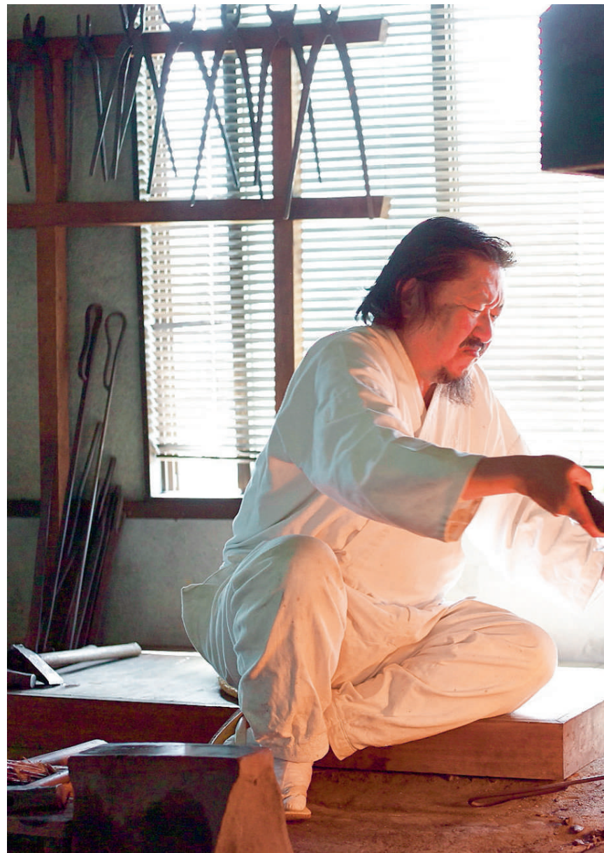
Oben: Der Stahl, der zum Fertigen von japanischen Waffen verwendet wird, heisst Tamahagane. Links: Auf einem Amboss wird der Stahl mehrfach umgefaltet und wieder flachgehämmert. Rechte Seite unten links: Der Stahl wird mit einer Tonmasse bestrichen, um die Oxidation während des Schmiedens zu minimieren. Rechte Seite unten Mitte: Mit einem Keil und Hammer schlägen der Assistenten von Fujiwara Kanefusa wird das Metall nahezu gespalten. Rechte Seite rechts: Das Eingravieren der Signatur des Schmieds in das Griffende erfolgt zu allerletzt.
